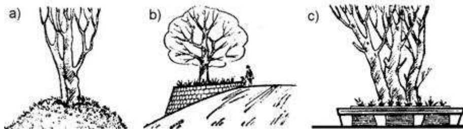
Rys. 2. Zabezpieczenie drzew przy obniżeniu terenu, po wykonaniu wykopów (wg N.P. Ornatski: Drogi i ochrona przyrody, Transport 1982)
